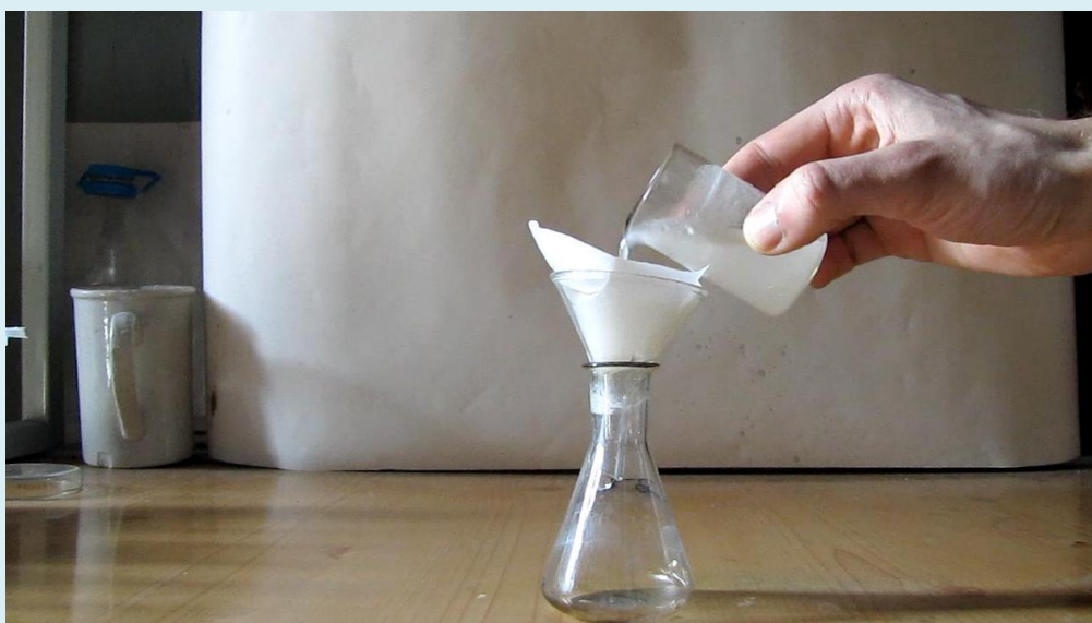
Фильтрация и промывка осадка перекиси ацетона
