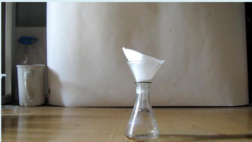
Фильтрация и промывка осадка перекиси ацетона
