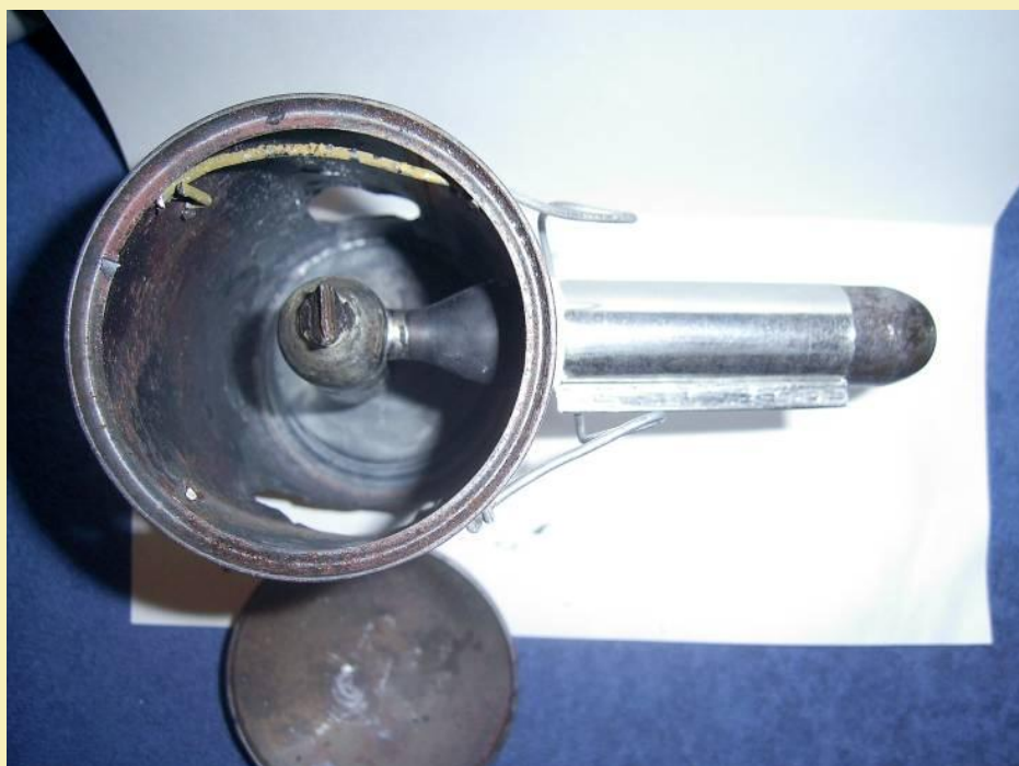
Установка для получения калия в собранном виде
