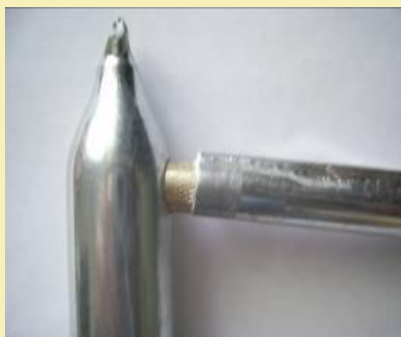
Соединение баллончик - Ф-разъемы – трубка
